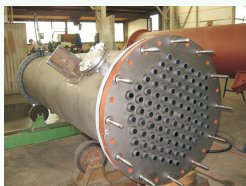
Rohrbündelwärmeaustauscher / Tubular heat exchanger
