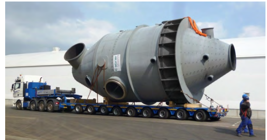
Evaporator Ø 6.000 mm, overall length 15.000 mm, 55 t
