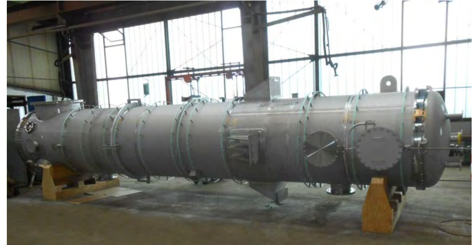
Конденсатор газообразных отходов Ø 1.800 мм, 1.4541
