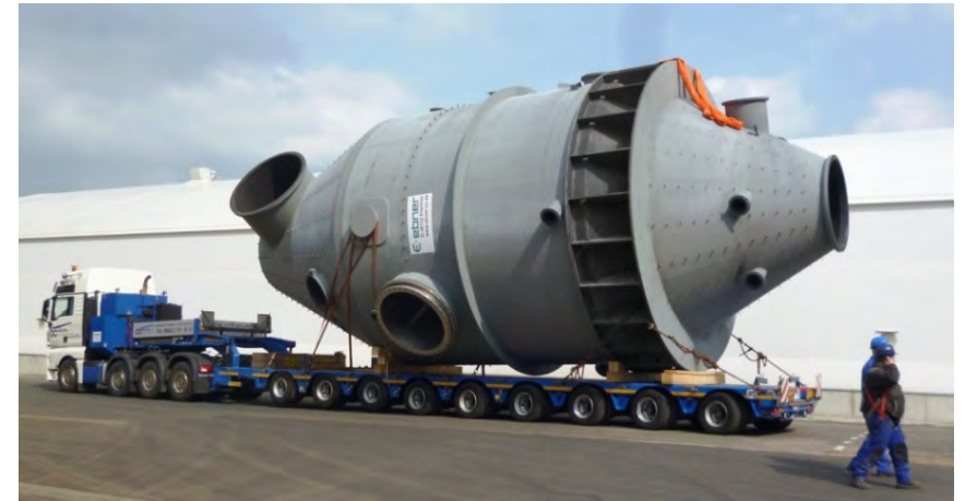
Испаритель Ø 6.000 мм, общая длина 15.000 мм, 55 т
