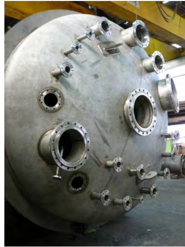
Реактор Ø 3.500 мм, 1.4539
