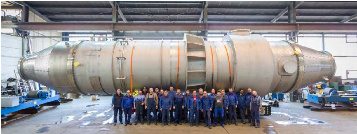
Теплообменник Ø 3.150 мм, длина труб 9.000 мм, 113 т
