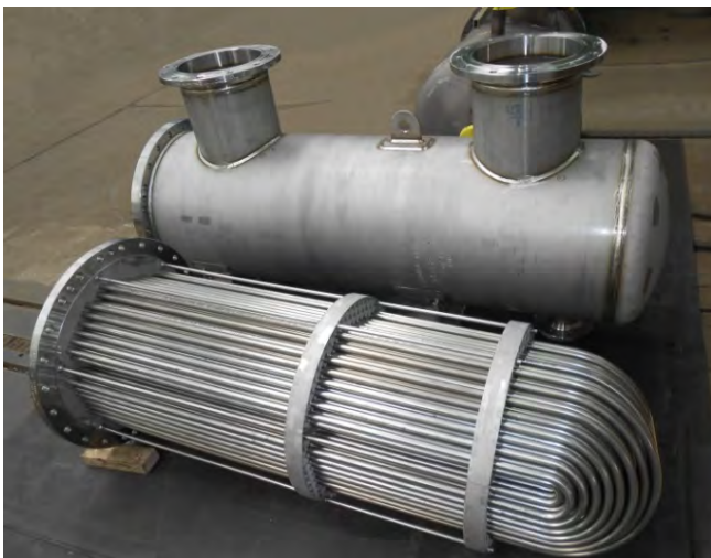
Конденсатор с выдвижным пучком Ø 610 мм, 1.4571
