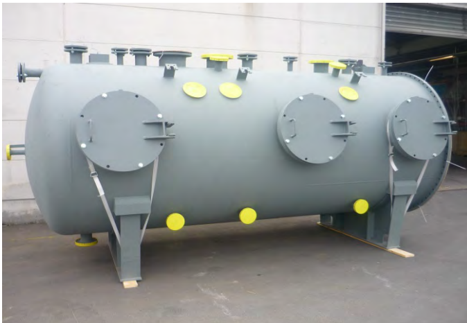
Часть кристаллизатора Ø 1.800 мм, сталь/гумированная 516 GR.60
