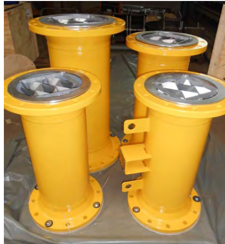
Смесители высокого давления Ø 250 мм, 1.4404 ASME с U-штампом
