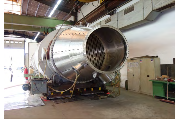
Теплообменники Ø 3.100 мм, общая длина 17.640 мм, вес 113 т Транспорт при помощи специального транспорта на воздушных подушках
