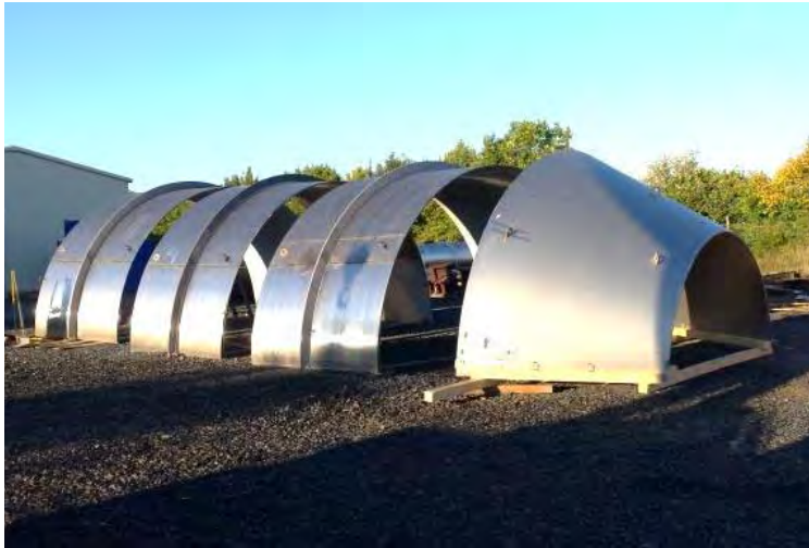
Сборка на строительной площадке и монтаж (Россия) Выпарной кристаллизатор Ø 5.400 мм, общая длина 21.800 мм, 40 т, 1.4562
