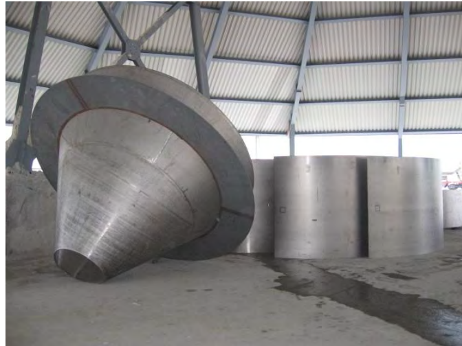
Сборка на строительной площадке и монтаж (Австрия) Выпарной кристаллизатор \varnothing 6.400 мм, общая длина 18.700 мм, 56 т, 1.4562
