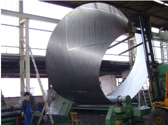
Сборка на строительной площадке и монтаж (Австрия) Выпарной кристаллизатор \varnothing 6.400 мм, общая длина 18.700 мм, 56 т, 1.4562
