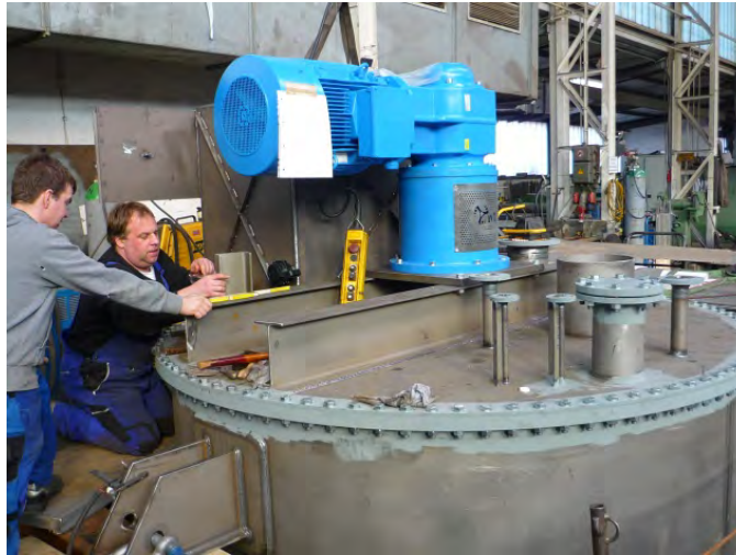
Изготовление и монтаж емкостей с мешалкой вкл. КИП (Германия) Ø 2.200 мм - Ø 3.000 мм, общая высота 5.700 мм, вес 7 - 11,6 т, сталь
