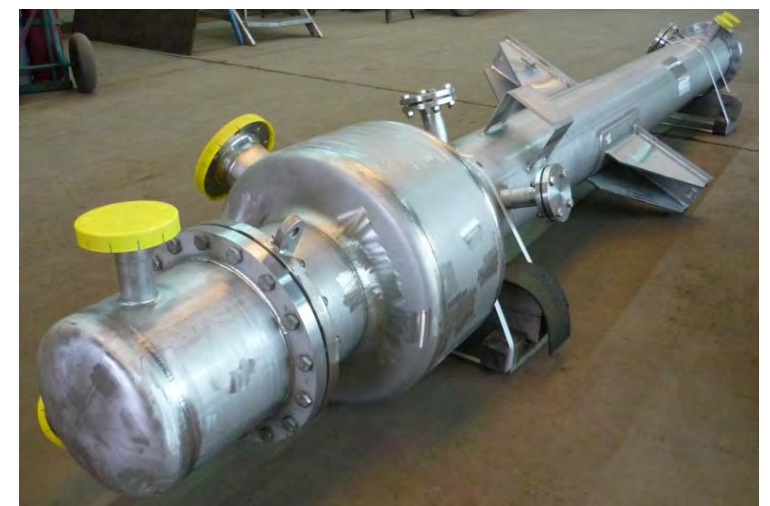
Нагреватель Ø 350 мм, 1.4539
