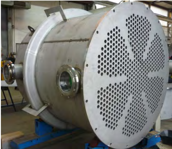
Конденсатор олеума Ø 1.650 мм, 1.4571
