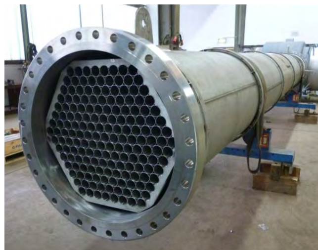
Направитель потока Ø 950 мм, 1.4404
