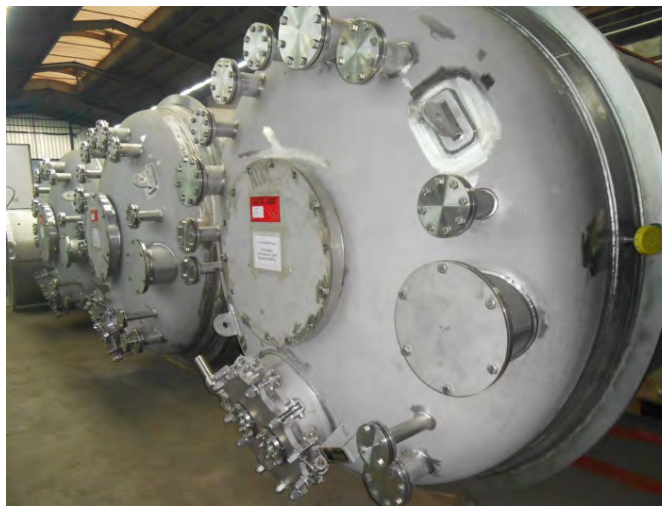
Аппарат с мешалкой Ø 2.400 мм, 1.4571
